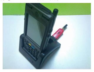
接続方法②:外付けポート(SNAP ON)を用いる方法
