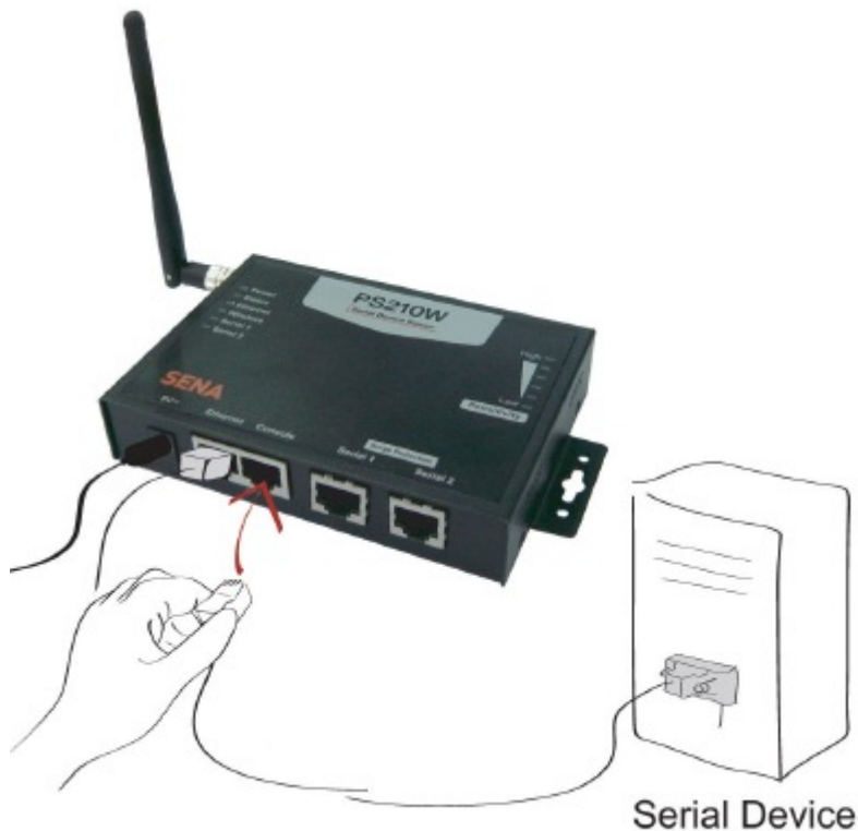
図 2-6 PS110W/PS210W にシステムコンソールケーブルをつなぐ
