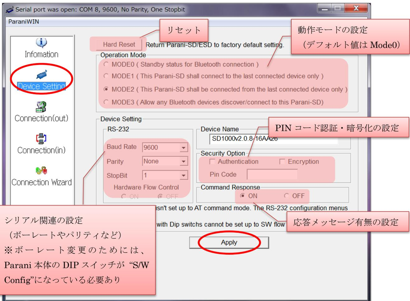
⑥設定がすべて完了したら、Parani 本体を一度電源 ON/OFF してから、ご使用下さい。
