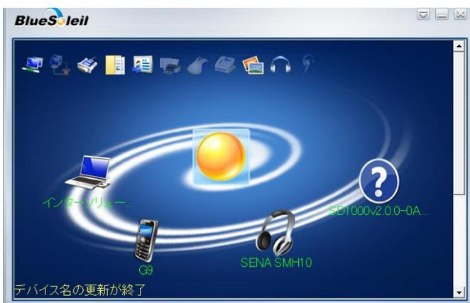
3. SD1000 のアイコン (?マーク) をダブルクリックします。「接続 Bluetooth シリアルポート」をクリックしてください。
