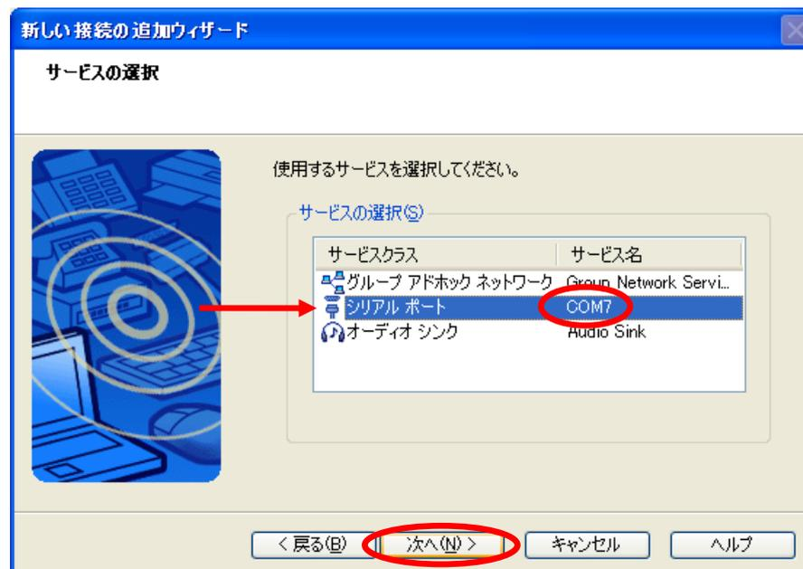
使用する COM ポートを選択し、“次へ”をクリックします。(この例ではデフォルトの COM ポートを使用する設定にしています)
