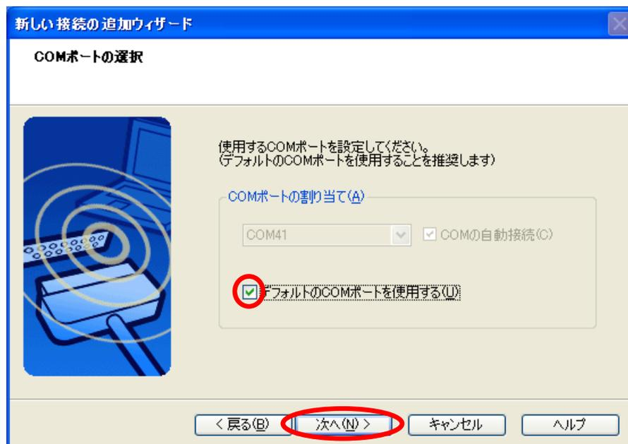
既に COM40 が PC (B)の接続設定で使用されているので、デフォルトとして **COM41** に設定されます。次画面でも、”次へ”をクリックします。
