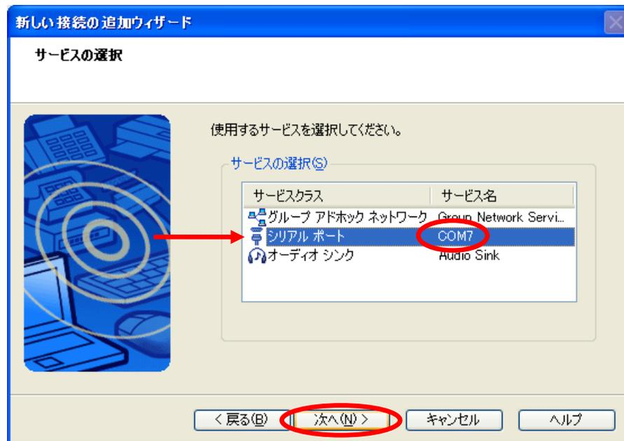
PC (A)側で使用する COM ポートを選択し、”次へ”をクリック。(この例ではデフォルトの COM ポートを使用する設定にしています)
