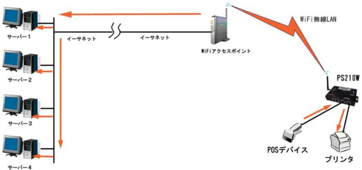
リモート・サイトにある様々なシリアル機器（バーコードリーダー・カードリーダー・スキャナ・POS 機器・分析装置・計測機器・表示パネル等）のデータをRS232 ケーブルでシリアル LAN 変換サーバーにつなぎ、無線 LAN アクセスポイントにデータを送信、そこから LAN/WAN につないで本社の管理 PC/サーバーにイーサネットケーブル経由でデータを送受信する。
