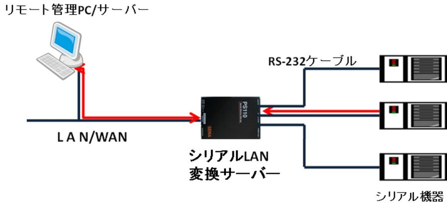
リモート・サイトにある様々なシリアル機器（バーコードリーダー・カードリーダー・スキャナ・POS 機器・分析装置・計測機器・表示パネル等）のデータをRS232 ケーブルでシリアル LAN 変換サーバーにつなぎ、LAN に変換。本社の管理 PC/サーバーにイーサネットケーブル経由でデータを送受信する。
